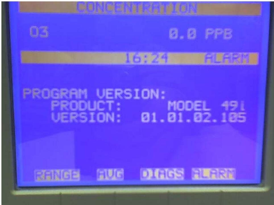
Abbildung 14: Anzeige der Softwareversion auf dem Analysatordisplay
