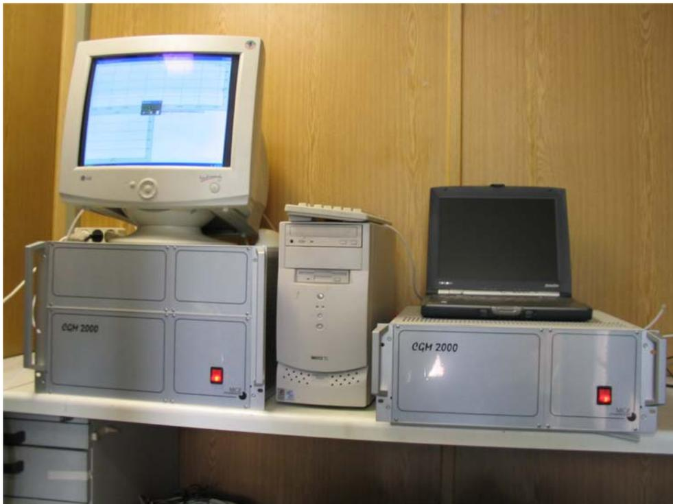
**Abbildung 4:** Aufbau des Ozongenerators und Rechner zur Ansteuerung
