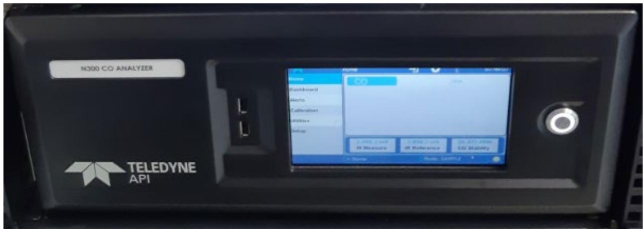
Abbildung 11: N300 Testgeräte mit Messwertanzeige
