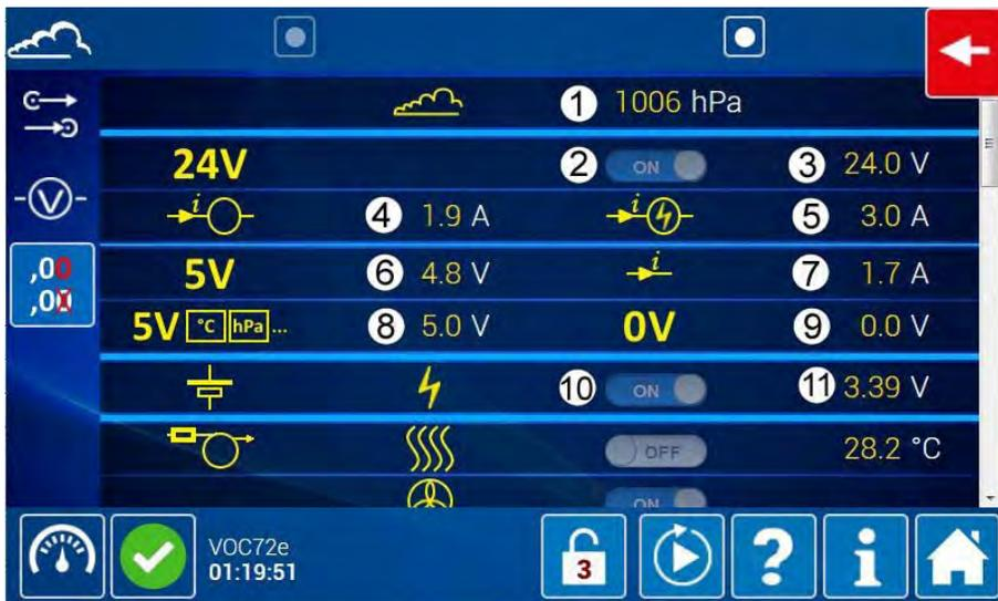
(1) Atmosphärendruck, (2) 24-V-Steuerung (EIN), (3) 24-V-Spannung, (4) Strom Peripherie, (5) Strom Hauptelemente, (6) Versorgungsspannung 5 V, (7) Versorgungsstrom 5 V, (8) Speisespannung 5 V Sensoren, (9) 0-V-Potential, (10) Stromversorgungsrelais des Desorbers (EIN), (11) Spannung der Batterie des Desorbers.
