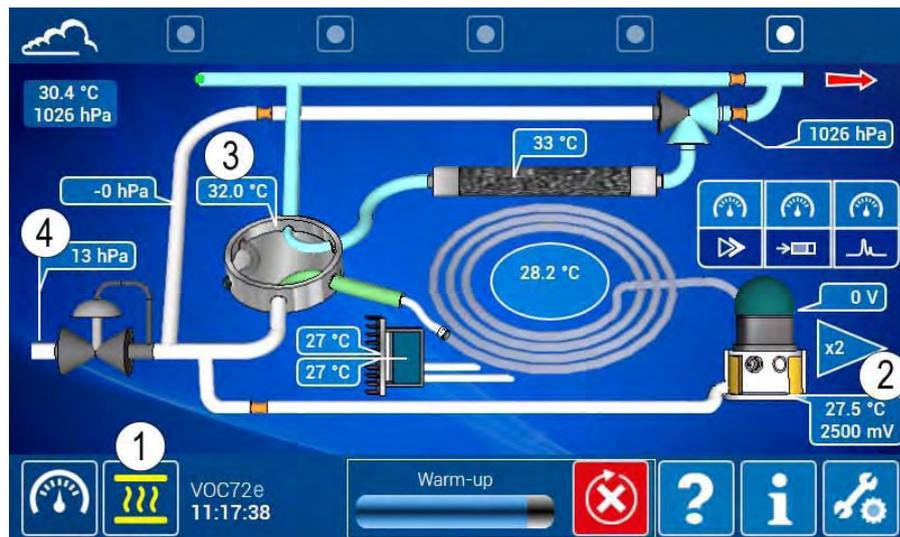
(1) Vorheizsymbol, (2) Temperatur des PID-Detektors (kalt), (3) Temperatur der Hot-Box, (4) Wasserstoffversorgungsdruck (relativ)
