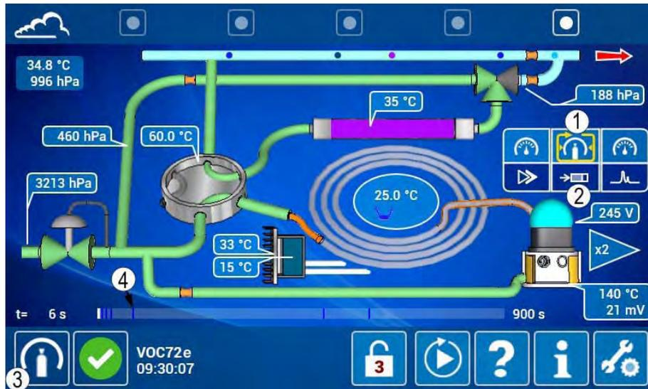
Im folgenden Zyklus hat der Analysatoreingang automatisch auf die Probegasposition (1) gewechselt und die Säule führt die Analyse der Prüfgasmischung (2) durch. Sobald der Fortschrittsbalken (3) die Berechnungsmarke (4) erreicht, ist die Erfassung des Prüfgaschromatogramms beendet und der automatische Kalibriervorgang beginnt.
