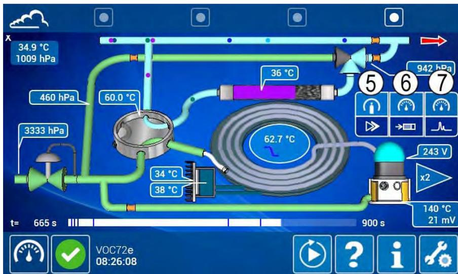
Im folgenden Zyklus wechselt das Symbol des Eingangselektors von Probengas auf Prüfgas (10), ohne dass der Bediener den Eingangselektor betätigt.
