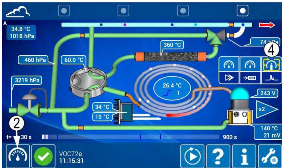
Am Ende des Kalibrierzyklus wird das Prüfgaschromatogramm erstellt. Dann werden abhängig vom Kalibriertyp die Kalibrierkoeffizienten und die Retentionszeiten der Verbindungen aktualisiert.
