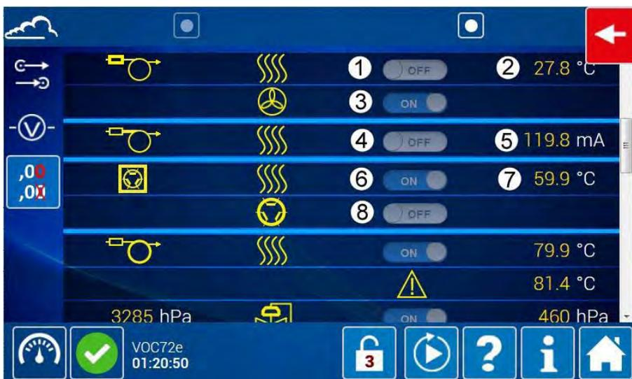
(1) Aufheizung der Gasfalle (AUS), (2) Temperatur der Gasfalle, (3) Belüftung der Gasfalle (EIN), (4) Aufheizung der Transferleitung (AUS), (5) Heizstrom der Transferleitung, (6) Aufheizung der Hot-Box (EIN), (7) Temperatur der Hot-Box, (8) Pilot-Magnet-Einspritzventil (AUS)
