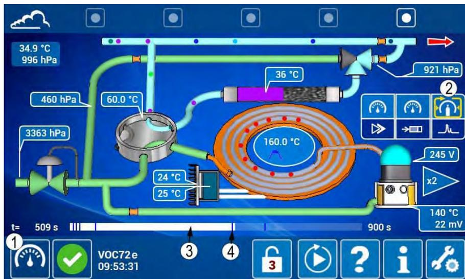
Für jede für die automatische Kalibrierung (2) ausgewählte Verbindung (1) werden die Retentionszeit (3) und der Detektorkoeffizient (4) automatisch angepasst.
