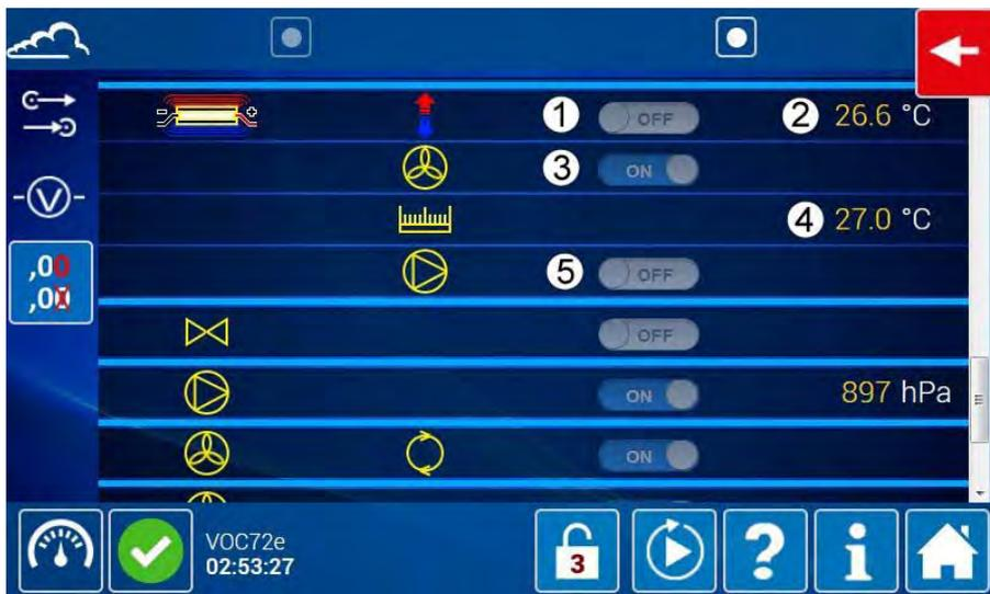
(1) Steuerung Peltier-Kühleinheit (AUS), (2) Temperatur der Kaltplatte, (3) Lüfter des Kühlkörpers (EIN), (4) Temperatur des Kühlkörpers, (5) Kühlpumpe (AUS).
