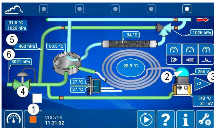
(1) „Bereit“-Symbol, (2) PID-Leuchte brennt, (3) Spannung des PID, (4) Proportionalventil aktiv, (5) Auf Sollwert eingestellter Säulendruck, (6) Eingestellter Wasserstoffversorgungsdruck.
