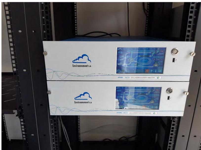
Abbildung 5: VOC72e Testgeräte mit Messwertanzeige
