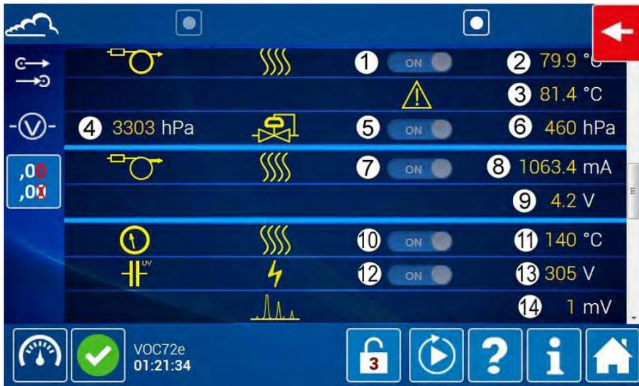
(1) Säulenheizung (EIN), (2) Säulentemperatur, (3) Sicherheitstemperatur der Säule, (4) Eingangsdruck des Trägergases, (5) Druckregelung (EIN), (6) Druckregelung der Säule, (7) Aufheizung der Säulenenden (EIN), (8) Strom Säulenenden, (9) Heizspannung der Säulenenden, (10) Aufheizung Detektor (EIN), (11) Temperatur Detektor, (12) Versorgung Detektor (EIN), (13) Spannung der PID-Lampe, (14) Detektorsignal.
