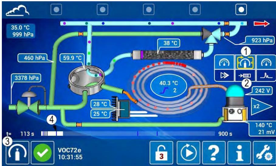
Im folgenden Zyklus hat der Analysatoreingang automatisch auf die Probegasposition (1) zurückgeschaltet und die Säule führt die Analyse der Prüfgasmischung (2) durch. Sobald der Fortschrittsbalken (3) die Berechnungsmarke (4) erreicht hat, ist die Erfassung des Chromatogramms beendet und der automatische Kalibriervorgang beginnt.
