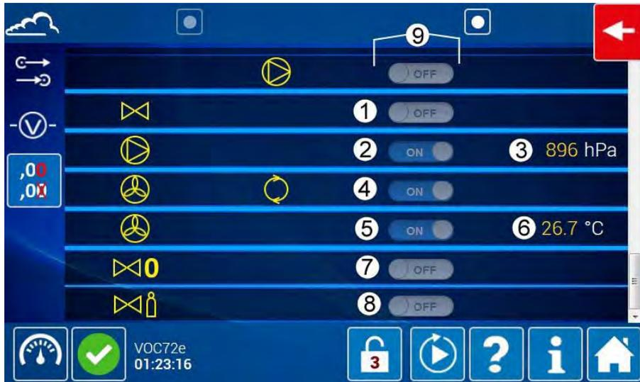
(1) Spülmagnetventil (AUS), (2) Probenahmepumpe (EIN), (3) Druck Gasfalle, (4) Mischlüfter (EIN), (5) Kühllüfter (EIN), (6) Innentemperatur, (7) Magnetventil Nullluft (AUS), (8) Magnetventil (AUS)
