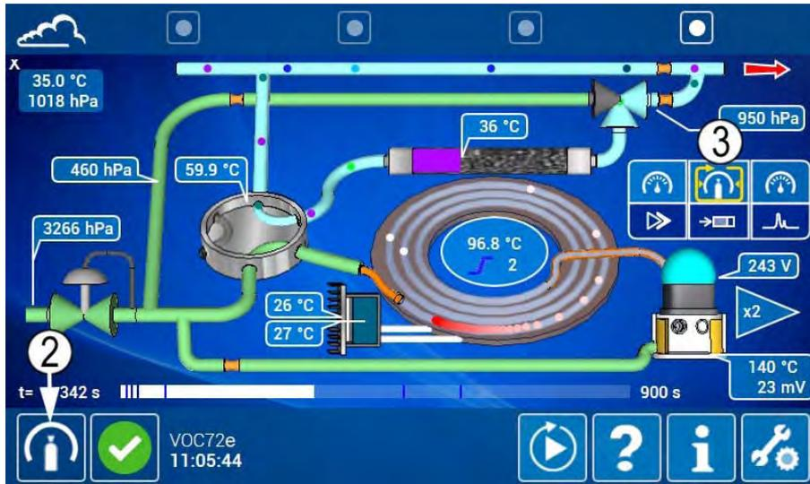
Im nächsten Zyklus wechselt das Symbol des Fluideingangsselektors (2) erneut in seinen ursprünglichen Zustand (Probe im folgenden Beispiel), während das Symbol des Kalibrierzyklus in den Rahmen wechselt, der den laufenden Analysezyklus symbolisiert (4).
