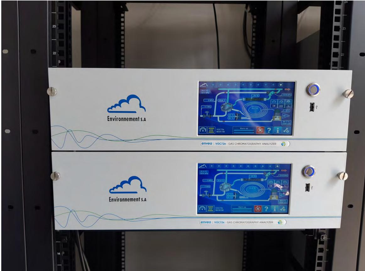
Abbildung 1: Darstellung der VOC72e Analysatoren
