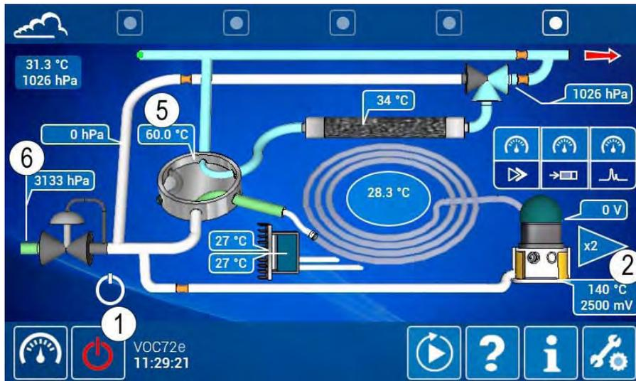
(1) Stand-by-Symbol, (2) PID-Detektor mit Solltemperatur, (5) Hot-Box mit Solltemperatur, (6) Eingestellter Wasserstoffversorgungsdruck.
