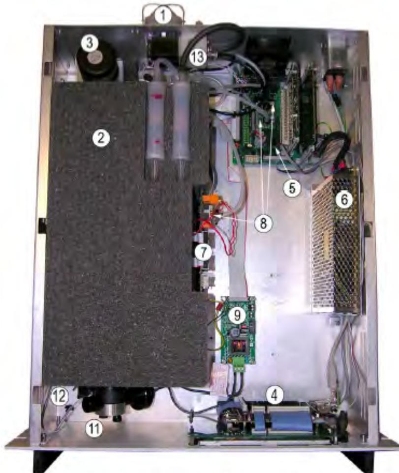
(1) Staubfilter am Probeneingang, (2) Messmodul, (3) Membranpumpe, (4) HMI-Karte, (5) Verbindungskarte, (6) 24-V-Versorgung, (7) Messkarte, (8) Drucksensorkarten, (9) Versorgungskarte UV-Lampe, (11) UV-Lampe, (12) Verschluss, (13) Filter-Magnetventil-Einheit.
