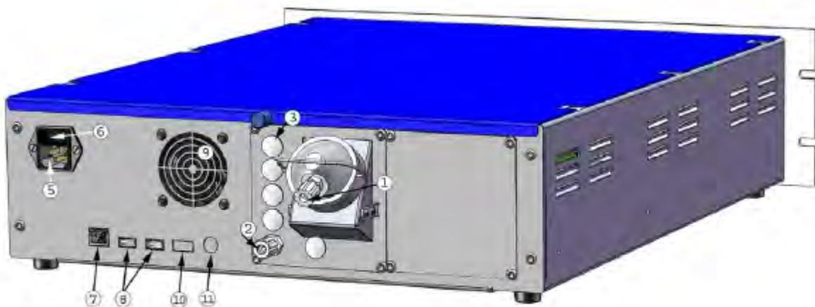
(1) Probegaseingang, (2) Pumpenausgang, (3) Prüfgaseingang, (5) dreipoliger Netzanschluss, (6) Hauptsicherung, (7) Ethernet-Ausgang, (8) zwei USB-Anschlüsse, (9) Ventilator, (10) Rückmeldung MV Nullluft und Prüfgas für das optionale externe Kalibrier-MV, (11) 24-V-Versorgung für optionale ESTEL-Karte.
