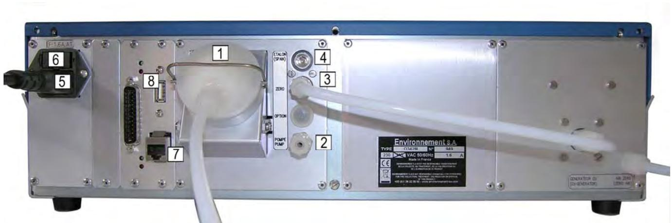
(1) Staubfilter, (2) Pumpenausgang, (3) und (4) Eingänge Nullluft-Prüfgas, (5) Netzanschluss, (6) Sicherung, (7) Ethernet-Ausgang, (8) USB-Anschluss
