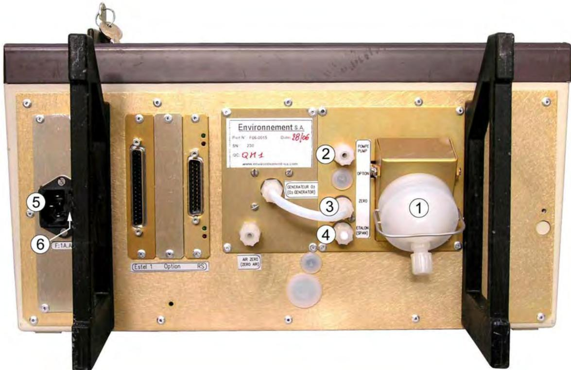
Abbildung 1-5 - Unterteil der Schrankversion
