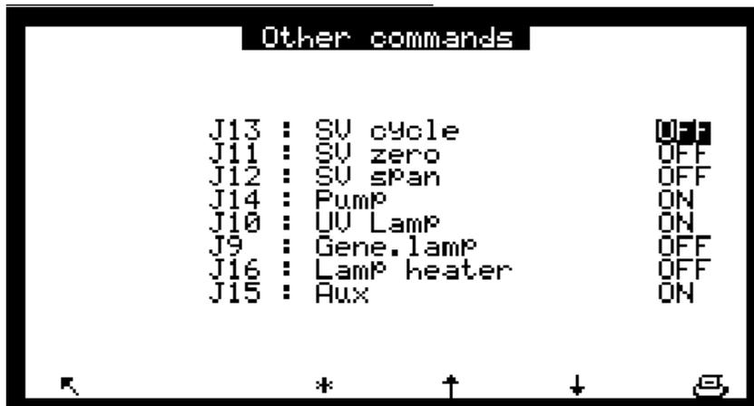
Jxx verweist auf die Nummern der Steckverbindungen der Modulkarte, MV verweist auf das Magnetventil.
