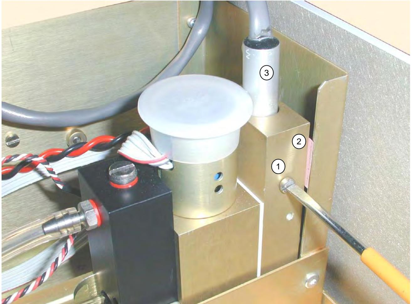
Abbildung 4-5 – Austausch der UV-Messlampe
