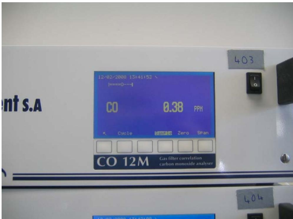
Abbildung 4: Frontalaufnahme der Messeinrichtung CO12M
