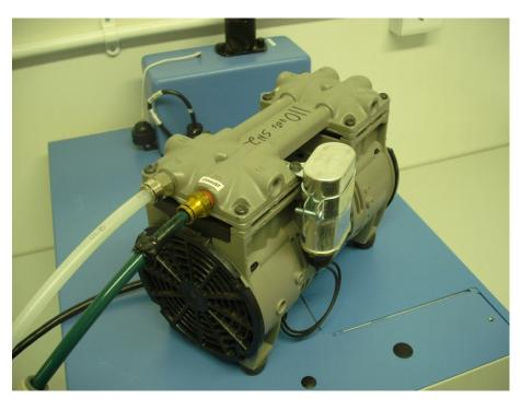
Figure 13: Vacuum pump (type: GAST Model 75R647, PN 110836-00)
