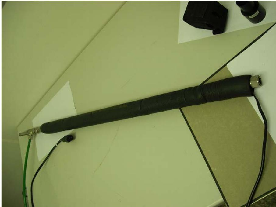
*Abbildung 5: Beheiztes Probenahmerohr (DHS)*
