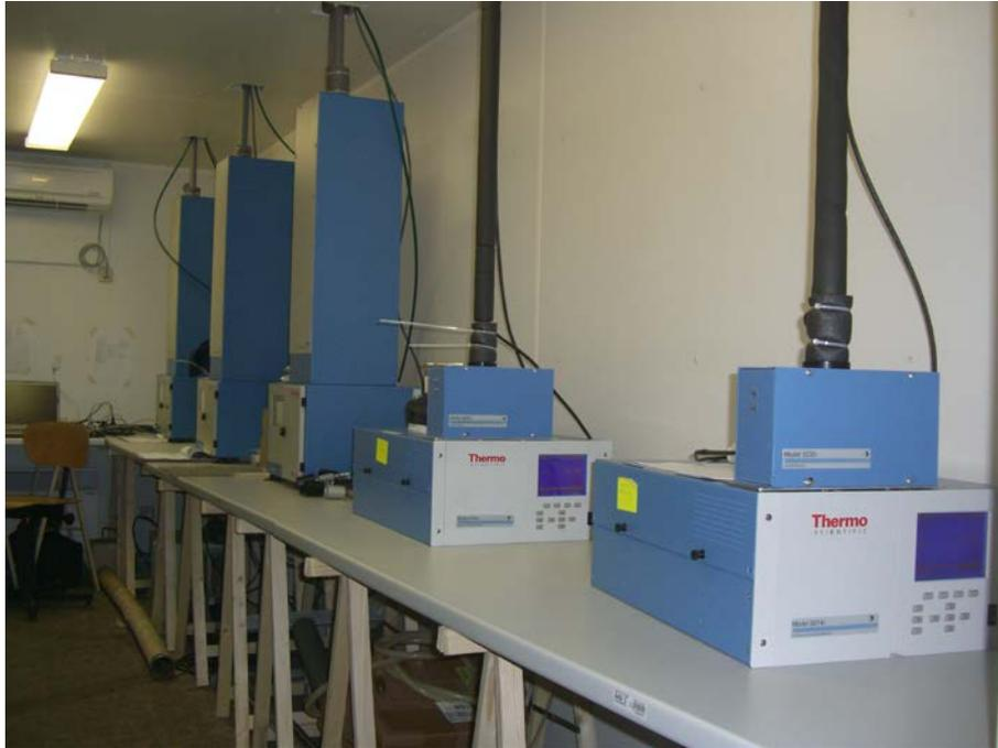
*Abbildung 7: Messgerät Modell 5014i Beta (1. & 2. System von rechts) in Messstation – hier als Modell 5030i SHARP mit zusätzlichem Nephelometerbauteil*
