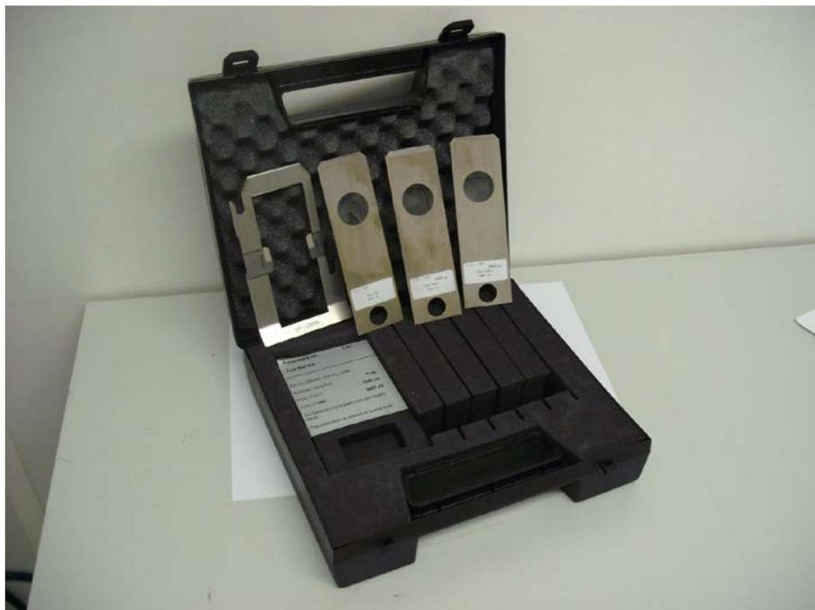
*Abbildung 12: Foliensatz mit Folienhalter und Prüffolien*
