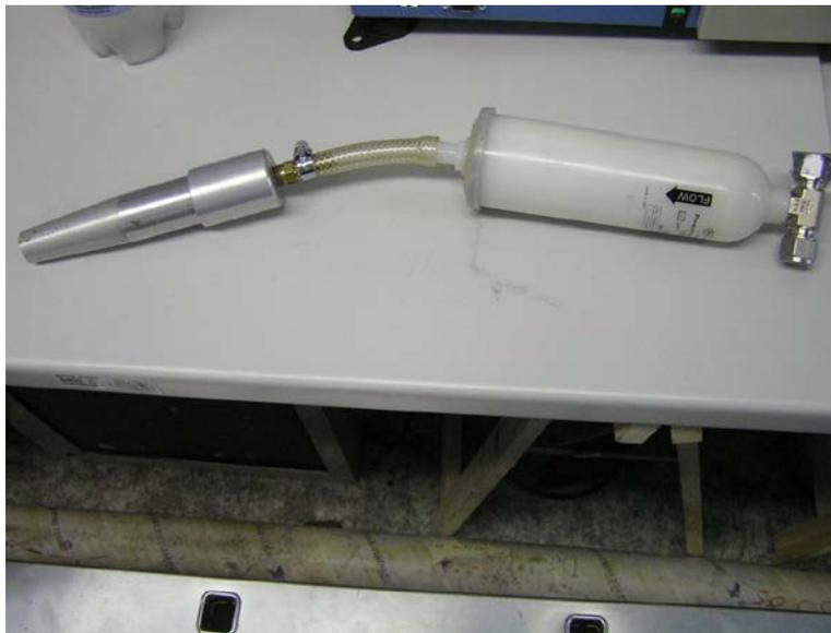
*Abbildung 11: Nullfilter zur Erzeugung von schwebstaubfreier Luft, inkl. Anschlussadapter*
