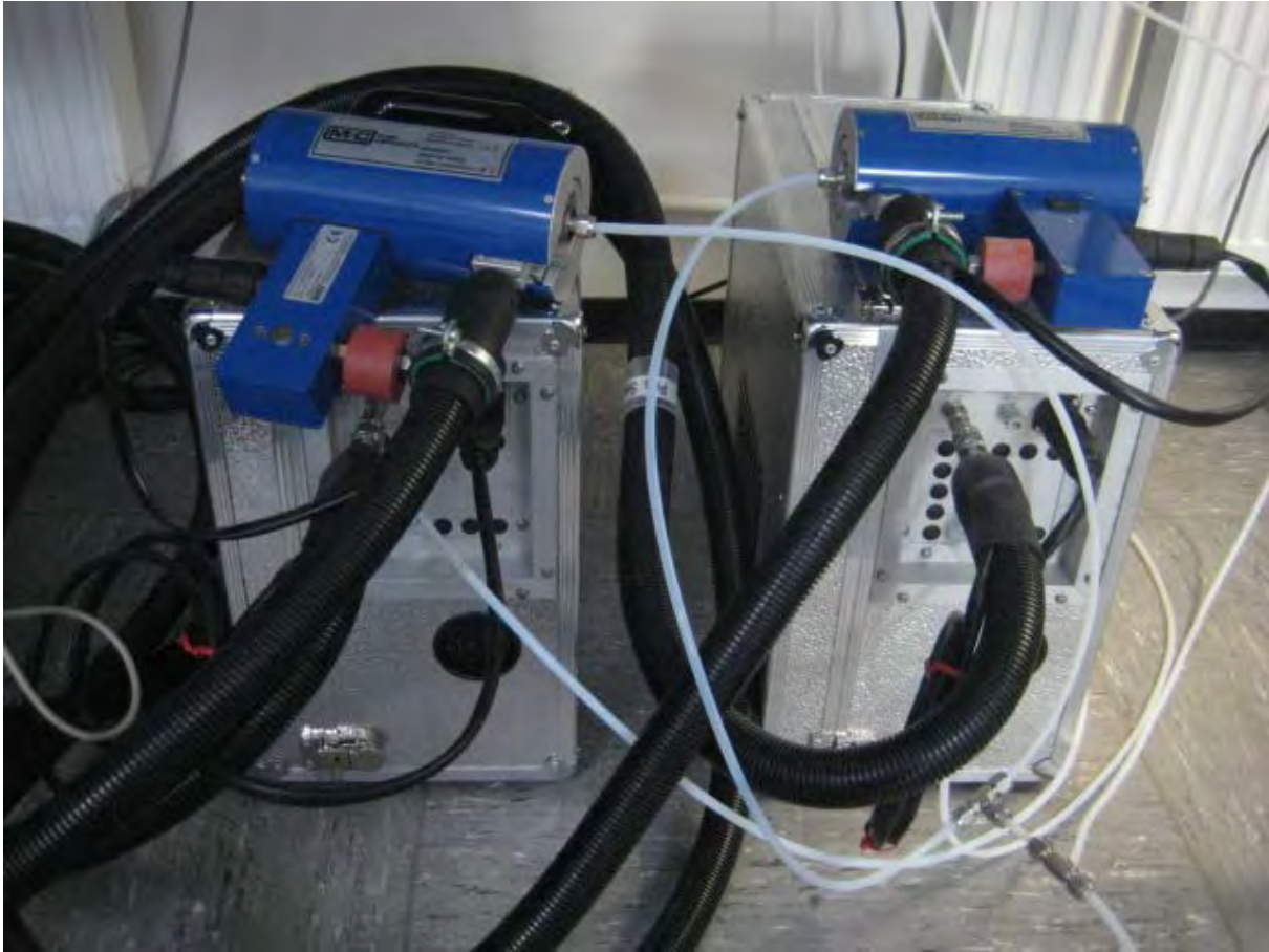
Abbildung 3: Beheizter Messgaskühler M&C PSS5 sowie Messgassonde M&C PS4000-H
