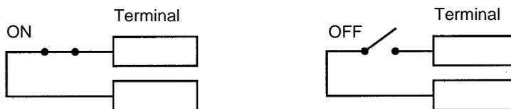
Fig. 90 **ON/OFF Status der Kontaktklemme**
