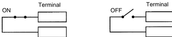
Fig. 89 ON/OFF Status der Kontaktklemme
