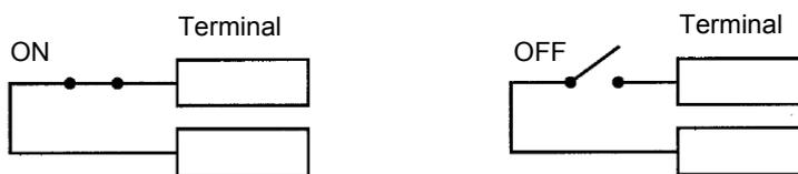
Fig. 87 ON/OFF Status der Kontaktklemme
