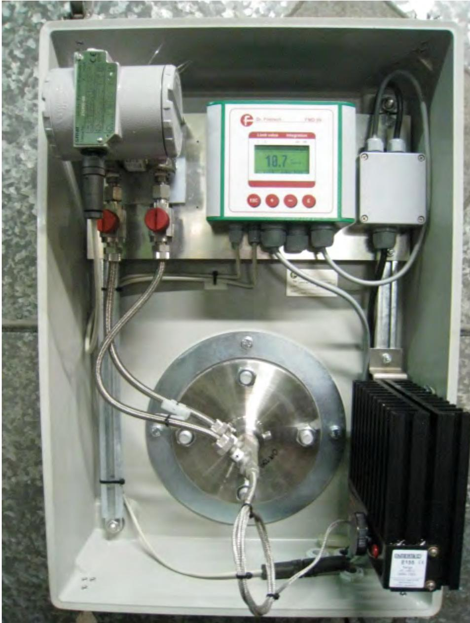
**Abbildung 2:** Sicht in das Wetterschutzgehäuse des Födisch FMD 09
