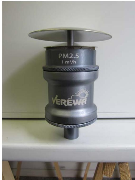
*Abbildung 3: Probenahmekopf PM<sub>2,5</sub>*
