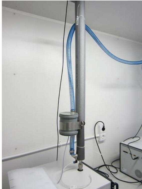
*Abbildung 4: Aktive Belüftung Probenahmesystem im Feldtest*
