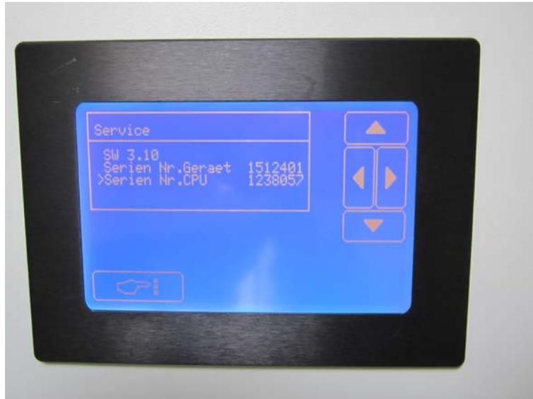
Abbildung 22: Anzeige der Softwareversion (hier 3.10) im Menü „Parameter/Service/SW“
