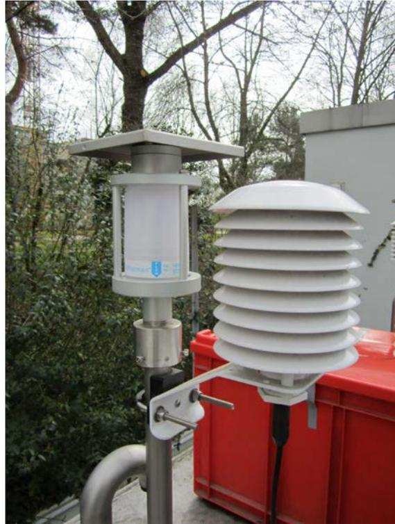
*Abbildung 6: Nullfilter zur Erzeugung schwebstaubfreier Luft, im Feldeinsatz*
