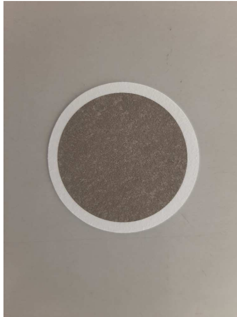
Abbildung 20: Membranfilter (EMFAB) nach 24 h-Probenahme
