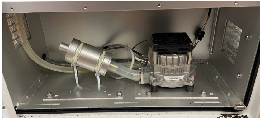
Abbildung 6: Position Gebläse/Lüfter (alt)
