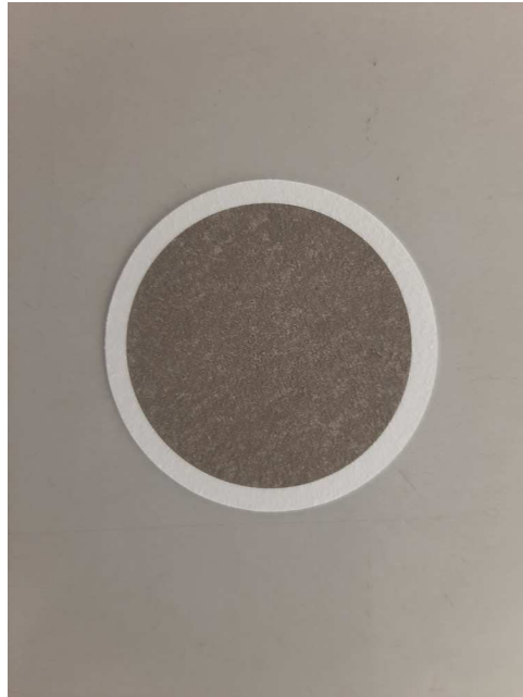
Abbildung 21: Faserbasierter Filter (Glasfaser) nach 24 h-Probenahme
