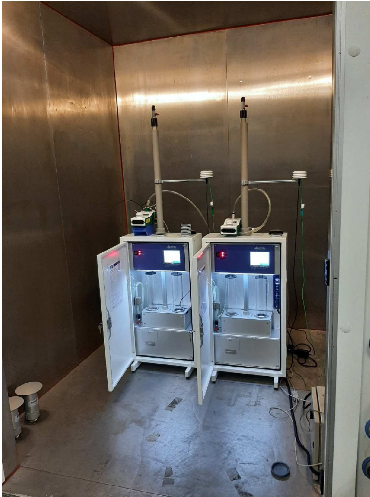
Abbildung 8: Aufbau DPA-14 Standard (ohne Kühlung der beaufschlagten Filter) in Klimakammer
