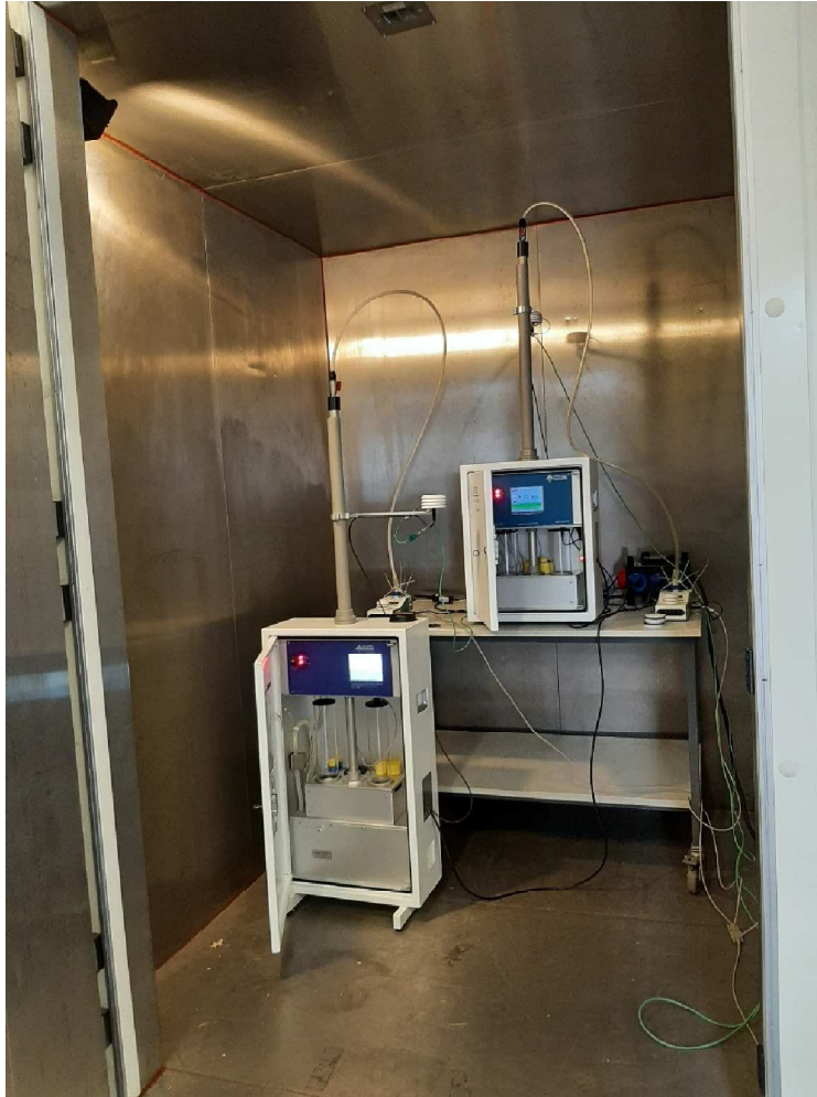
Abbildung 10: Aufbau DPA-14 Standard mit Pumpe (links) & DPA-14 Baby (rechts) in Klimakammer
