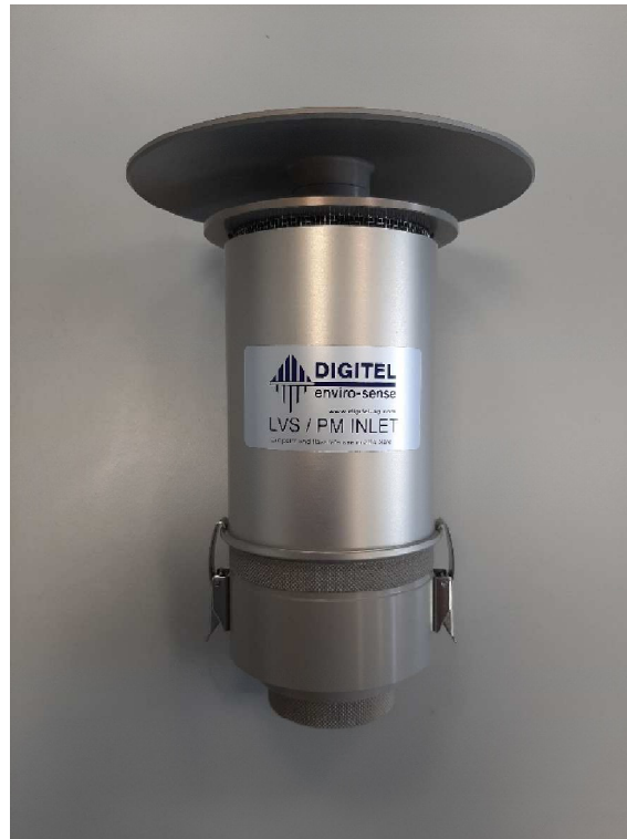
Abbildung 6: Standard-Probeneinlass für PM 2,5 , montiert
