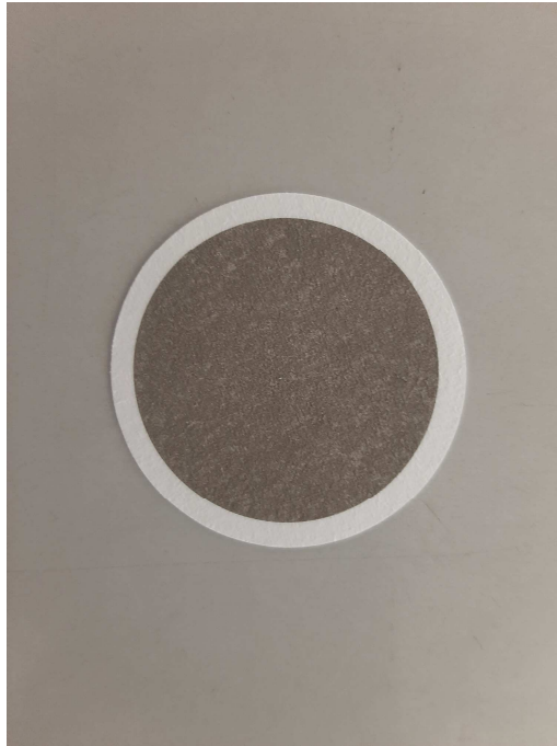
Abbildung 12: Membranfilter (EMFAB) nach 24 h-Probenahme
