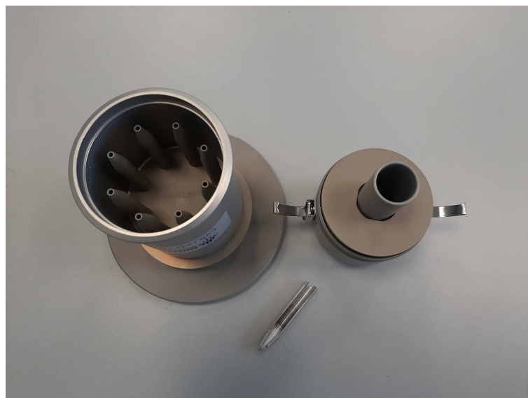
Abbildung 7: Standard-Probeneinlass für PM 2,5 , demontiert
