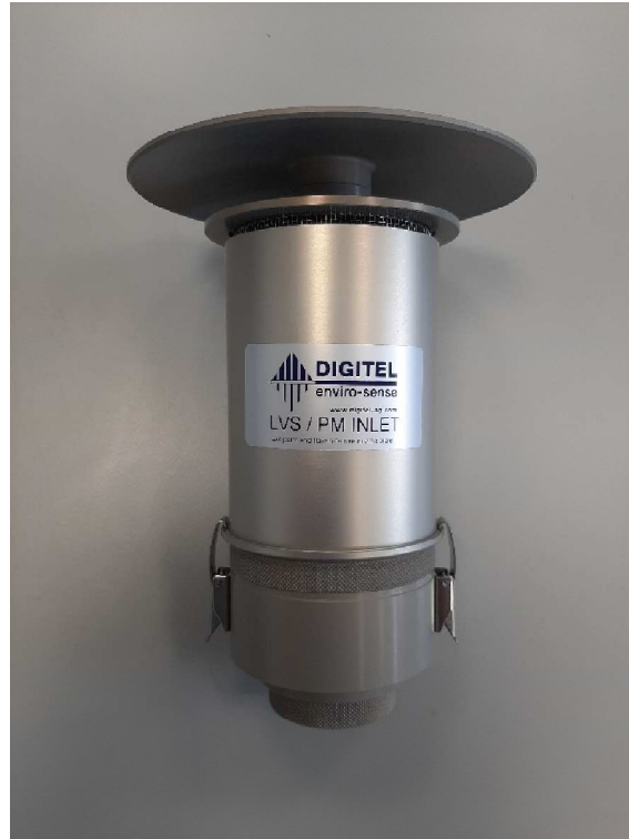
Abbildung 9: Standard-Probeneinlass für PM 10 , montiert
