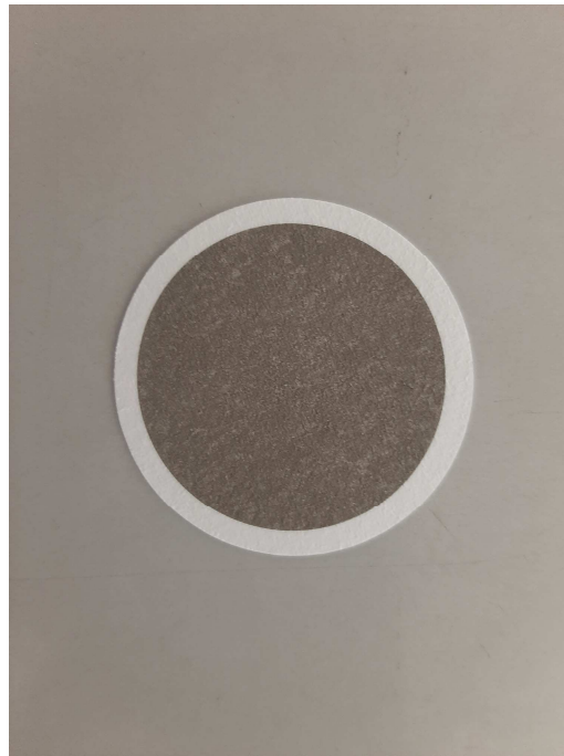
Abbildung 13: Faserbasierter Filter (Glasfaser) nach 24 h-Probenahme
