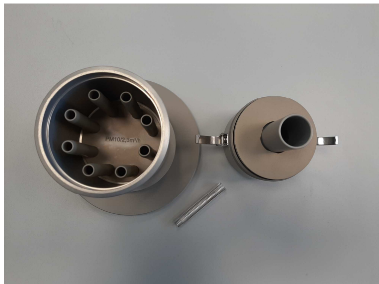
Abbildung 10: Standard-Probeneinlass für PM 10 , demontiert
