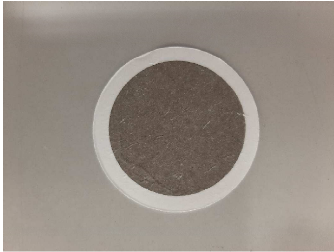
Abbildung 16: Faserbasierter Filter (Glasfaser) nach 24 h-Probenahme
