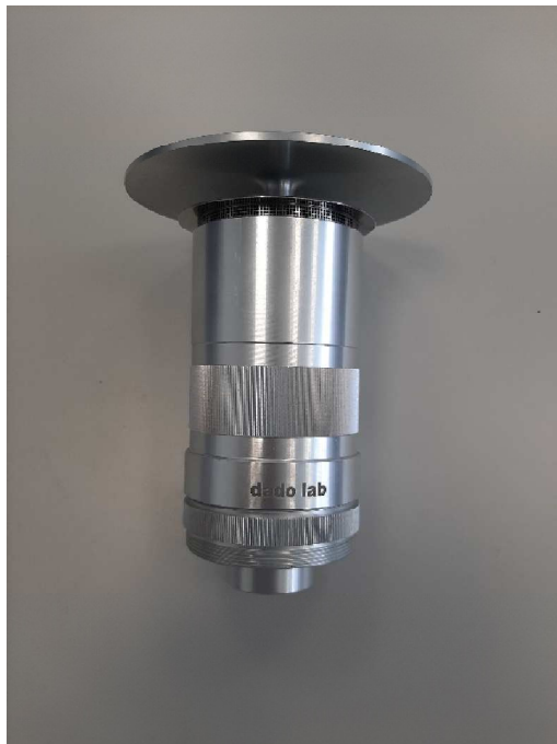
Abbildung 12: Standard-Probeneinlass für PM 10 , montiert
