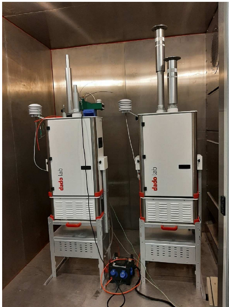
Abbildung 6: Aufbau SQ121A220240193 & SQ121A220240199 in Klimakammer
