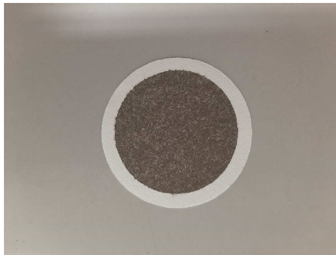
Abbildung 15: Membranfilter (EMFAB) nach 24 h-Probenahme
