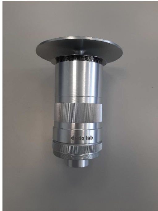
Abbildung 9: Standard-Probeneinlass für PM 2,5 , montiert
