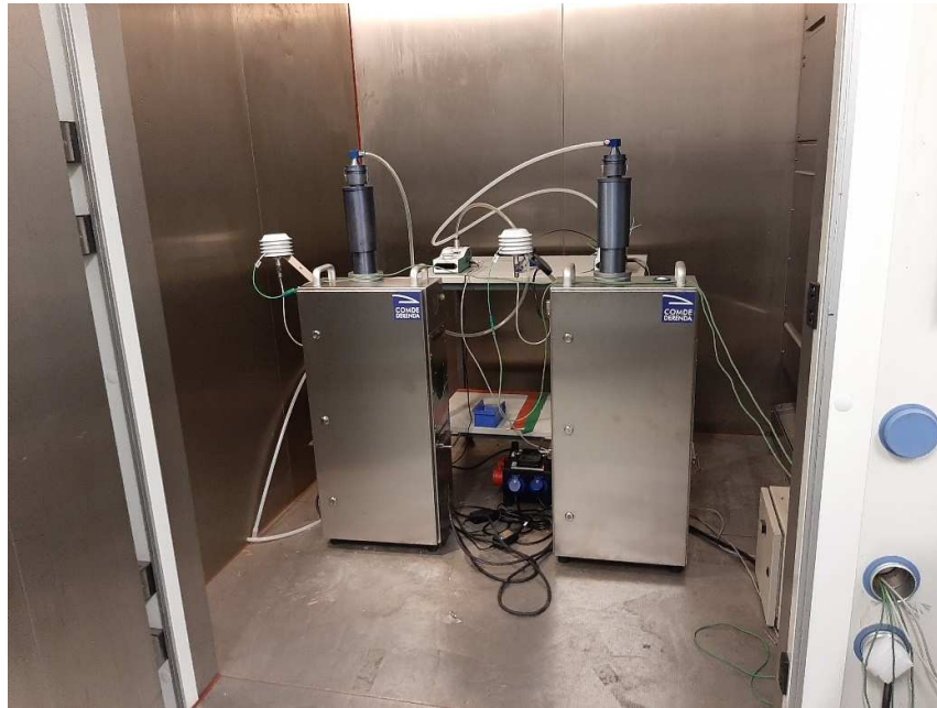
Abbildung 3: Aufbau PNS NG T-DM in Klimakammer
