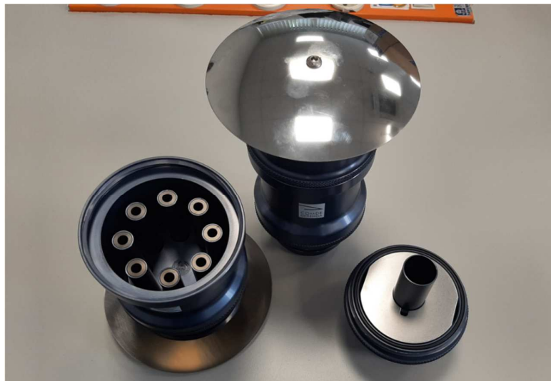
Abbildung 12: Standard-Probeneinlass für PM 10 , demontiert
