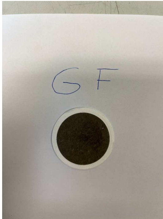
Abbildung 15: Faserbasierter Filter (Glasfaser) nach > 24 h-Probenahme
