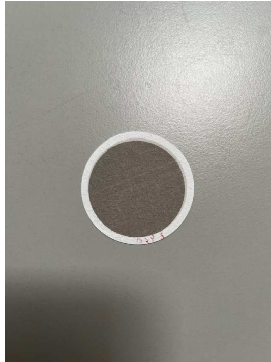
Abbildung 14: Membranfilter (EMFAB) nach > 24 h-Probenahme
