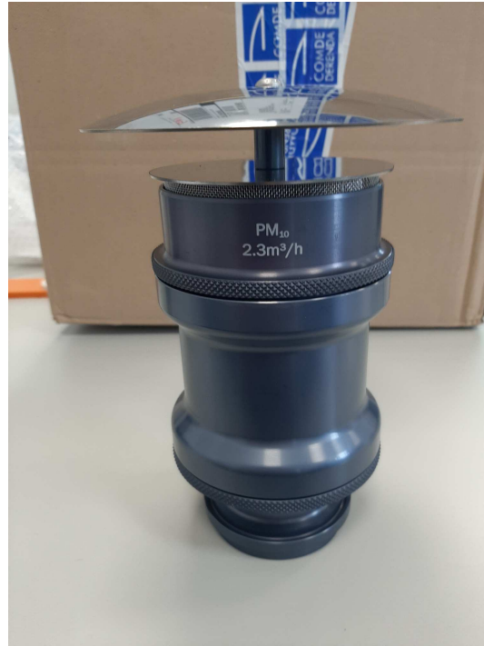
Abbildung 11: Standard-Probeneinlass für PM 10 , montiert
