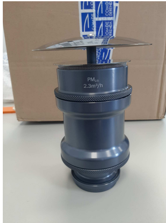
Abbildung 8: Standard-Probeneinlass für PM 2,5 , montiert
