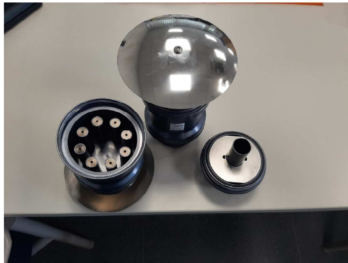
Abbildung 9: Standard-Probeneinlass für PM 2,5 , demontiert
