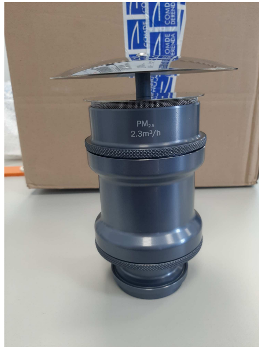
Abbildung 13: Standard-Probeneinlass für PM 2,5 , montiert
