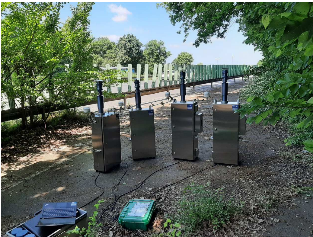
Abbildung 9: Feldteststandort Bornheim (Autobahn A555) – Prüflinge PNS T-DM-3.1 rechts im Bild
