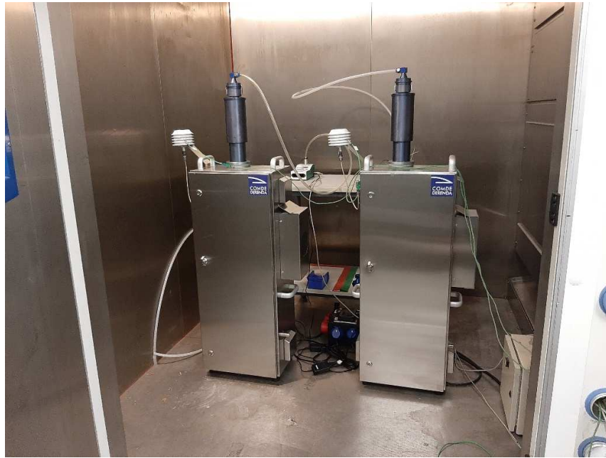
Abbildung 7: Aufbau PNS T-DM in Klimakammer
