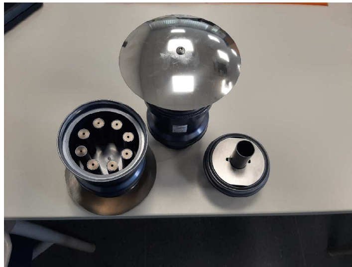
Abbildung 14: Standard-Probeneinlass für PM 2,5 , demontiert
