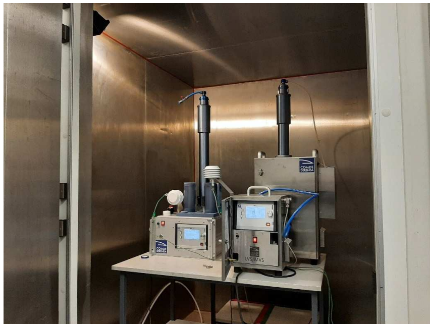
Abbildung 8: Aufbau PNS DMC (links) und PNS DM (rechts) in Klimakammer
