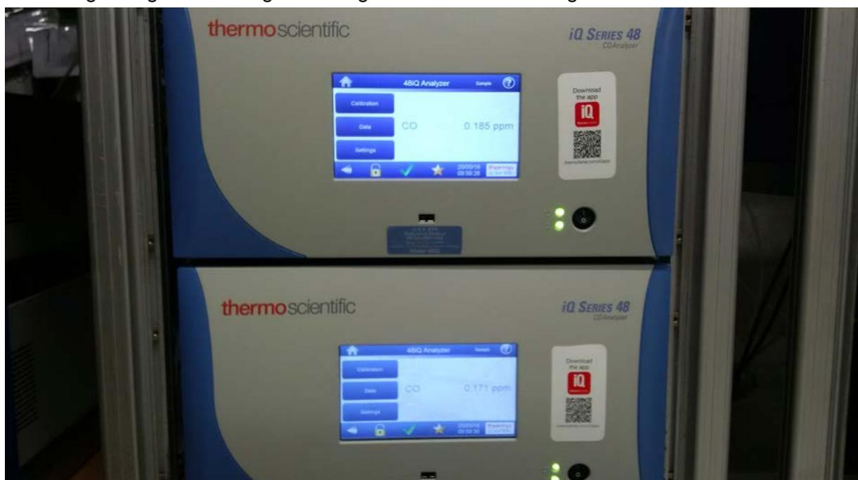
Abbildung 6: 48iQ Testgeräte mit Messwertanzeige
