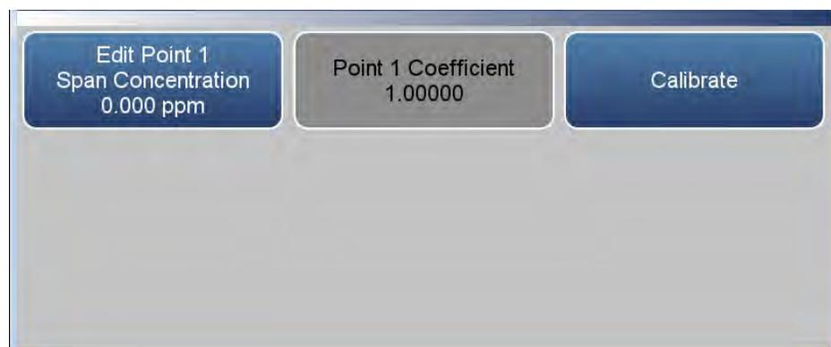
4. Geben Sie die Messbereichskonzentration ein, die dem Gerät zugeführt wird. Drücken Sie **Calibrate** (Kalibrieren).
