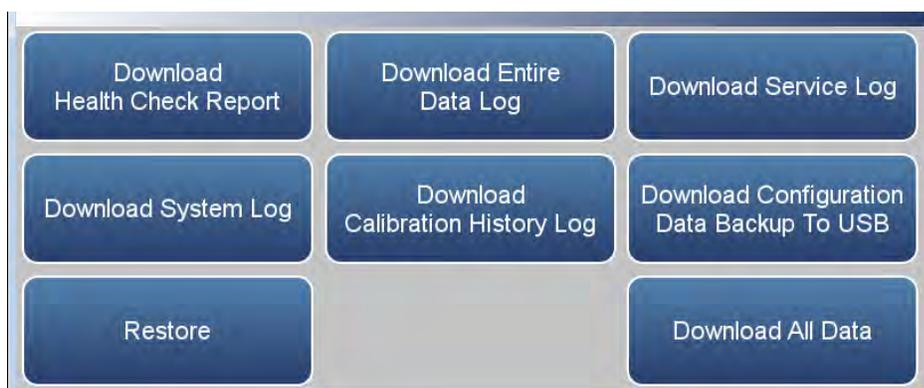
5. Das Gerät zeigt die Meldung „downloading data“ (Daten werden exportiert) an und beginnt mit der Datenübertragung an das USB-Laufwerk.
