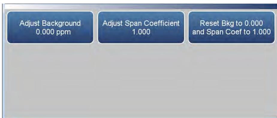
**Startbildschirm > Calibration (Kalibrierung) > Advanced Calibration (Erweiterte Kalibrierung) > Manual Calibration (Manuelle Kalibrierung) (dualer oder automatischer Bereichsmodus)**
