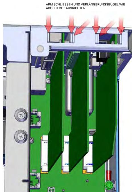
Abbildung 7–18. Austausch der E/A-Karten, Arm schließen und Ausrichtung
