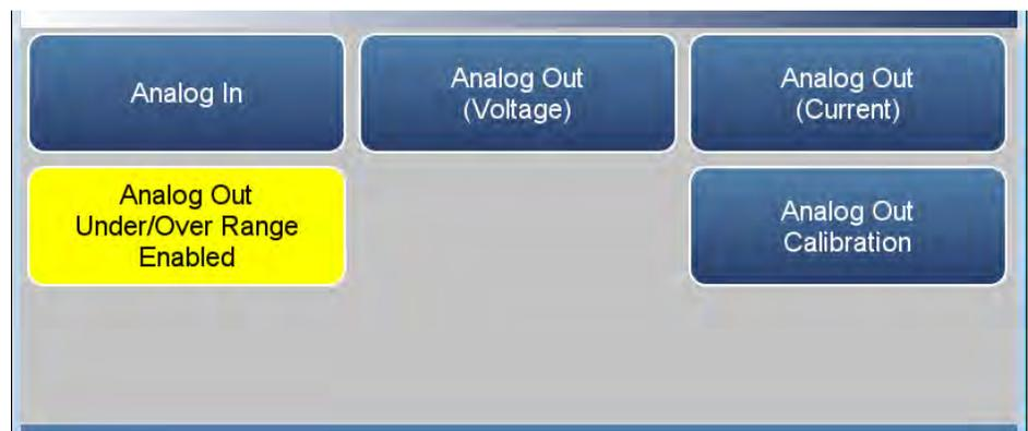
2. Wählen Sie je nach dem verwendeten Ausgangstyp entweder „Analog Out Zero Calibration (Voltage)“ (Nullkalibrierung des Analogausgangs (Spannung)) oder „Analog Out 4.000 mA Calibration (Current)“ (4,000 mA-Kalibrierung des Analogausgangs (Strom)) aus.
