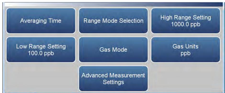
Das Menü „Measurement Settings“ (Messungseinstellungen) enthält folgende Elemente:
