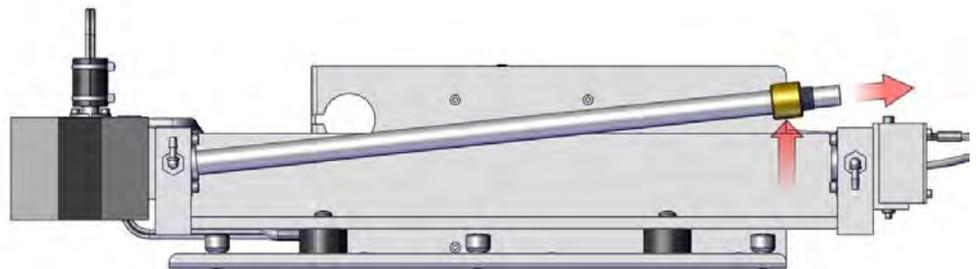
**Abbildung 5-4.** Ausbau der Absorptionsröhren
