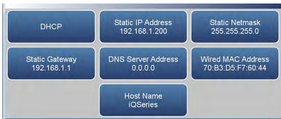
Der Bildschirm „Wired TCP/DHCP“ (Kabel-TCP/DHCP) enthält folgende Elemente:
