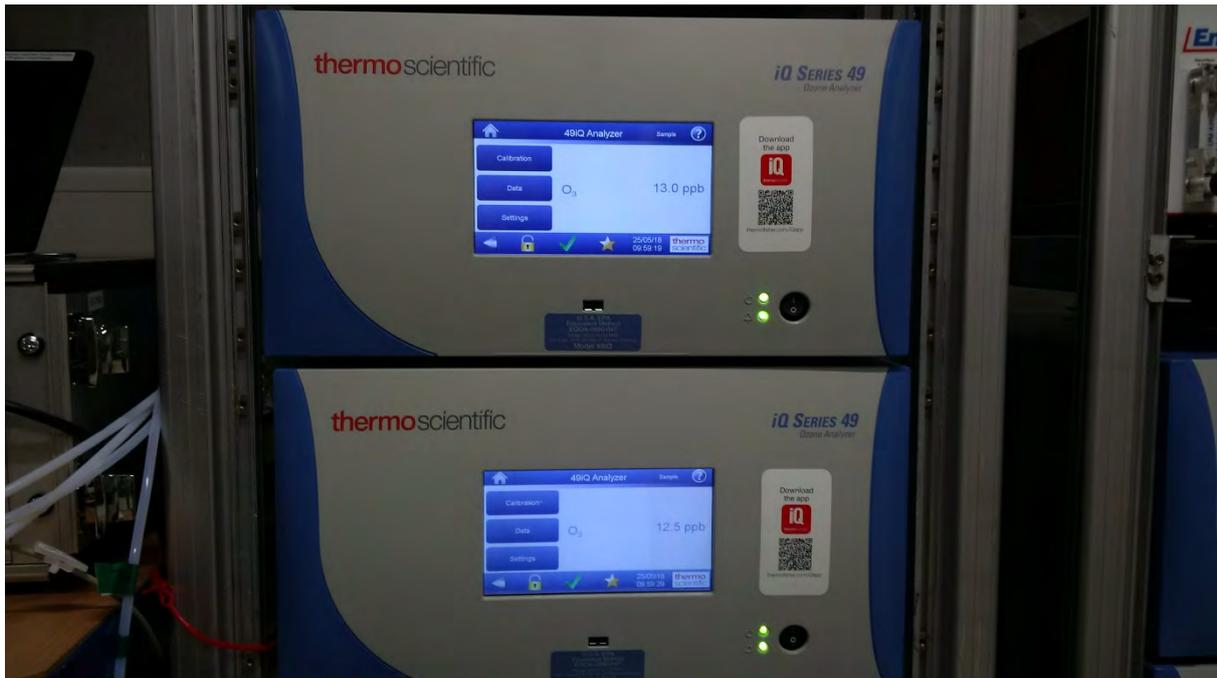
Abbildung 1: Darstellung des 49iQ Analysators
