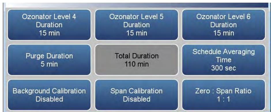
Der Bildschirm „Zero/Span Schedule“ (Geplante Nullpunkt-/Messbereichskalibrierung) enthält folgende Elemente:
