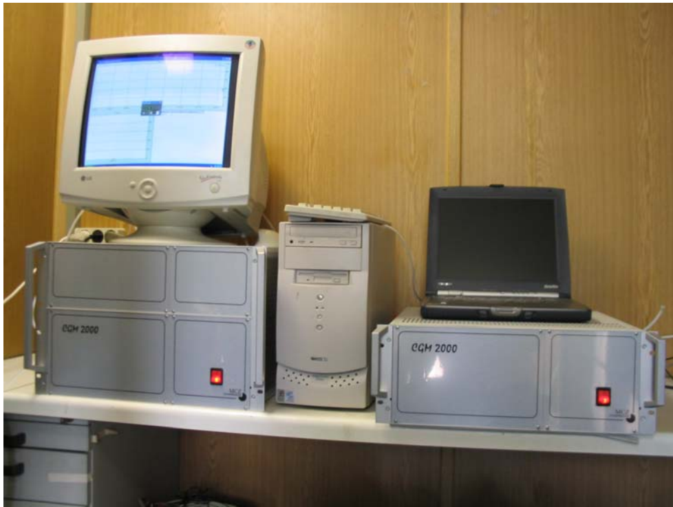
Abbildung 4: Aufbau des Permeationsofens und des Rechners zur Ansteuerung
