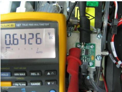
Abbildung 49 – Typischer Messwert der Prüfkontakten für die Messung des Zellendrucks (unter Anwendung einer Vakuumquelle an der Abluftöffnung)
