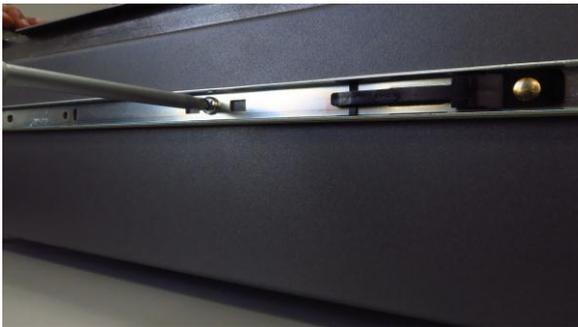
Abbildung 62 – Befestigung der inneren Profile auf dem Gehäuse
