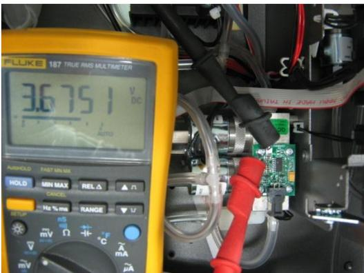
Abbildung 50 – Typischer Messwert der Prüfkontakten für die Messung des Verteilerdrucks
