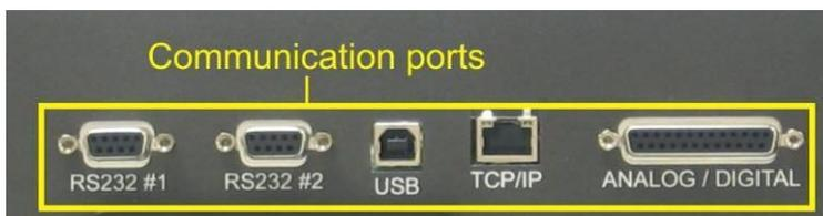
Abbildung 12 – Kommunikationsschnittstellen
