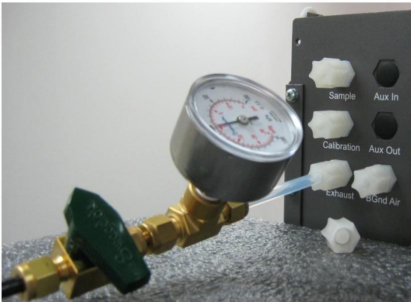
Abbildung 45 – Manometer an der Abluftöffnung
