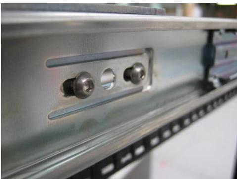
Abbildung 63 – Festschrauben der Rackbefestigungsadapter an die äußere Profile
