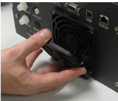
Abbildung 42 – Entfernen des Ventilatorfilters
