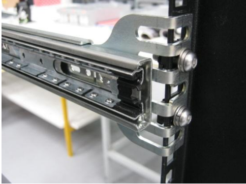
Abbildung 50 – Montage der inneren Profile auf dem Gehäuse
