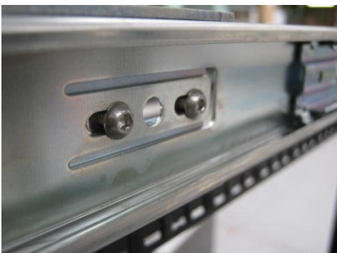
Abbildung 49 – Festschrauben der Rackbefestigungsadapter an die äußere Profile
