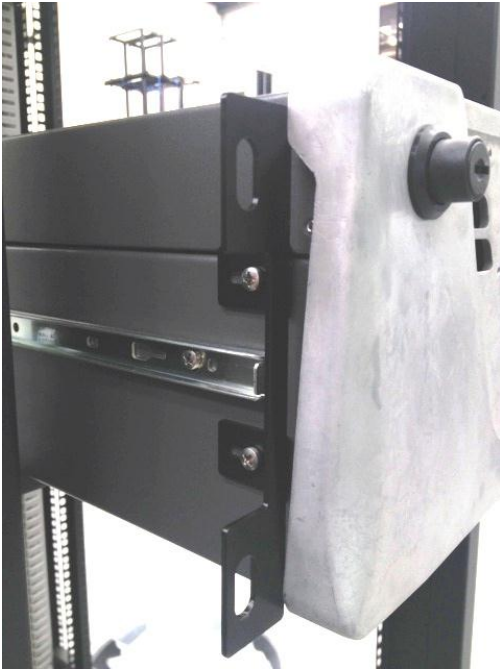
Abbildung 53 – Einpassen des Serinus in die Gleitschienen
