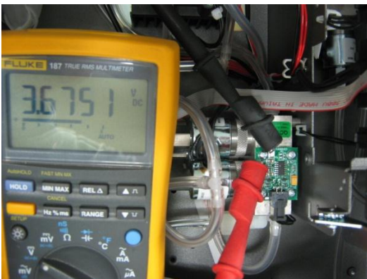
Abbildung 42 – Typischer Messwert der Prüfkontakte für die Messung des Zellendrucks
