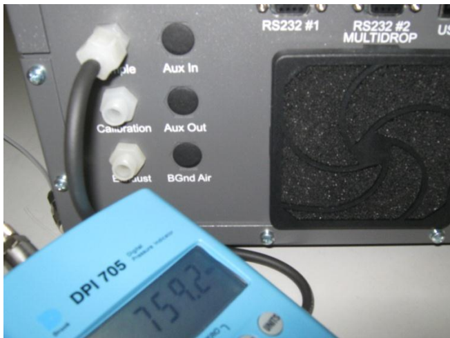
Abbildung 29 – Druckkalibrierung, externes Druckmessgerät
