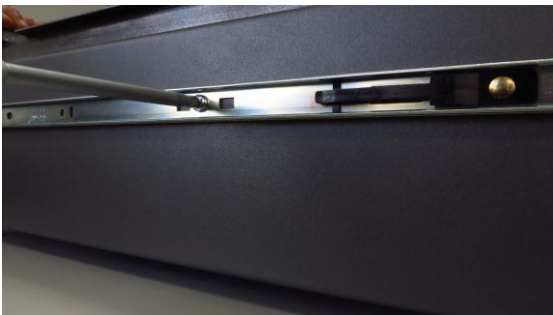
Abbildung 48 – Befestigung der inneren Profile auf dem Gehäuse
