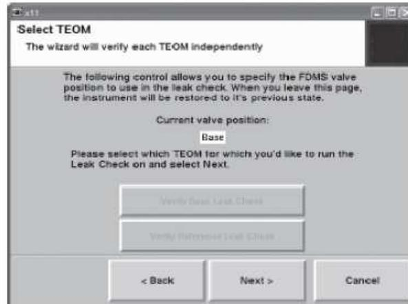
Screen „Assistent Dichtigkeitsprüfung“ / beide Ventilpositionen nicht verfügbar
