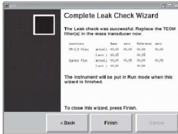
Screen „Assistent Dichtigkeitsprüfung“ / Prüfung erfolgreich abgeschlossen
