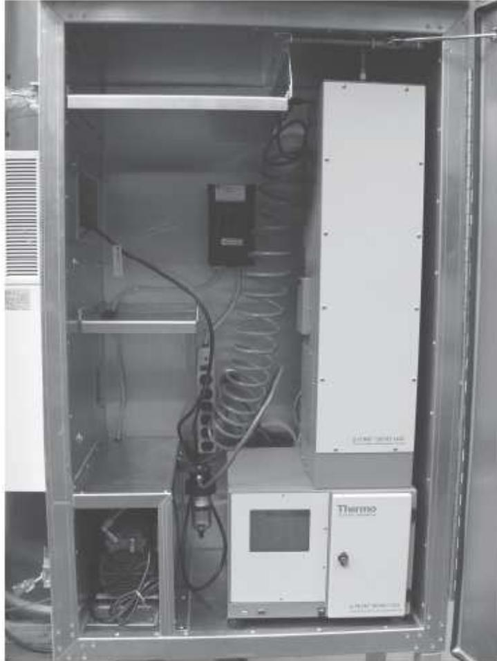
Messgerät im Schutzgehäuse für Betrieb im Freien
