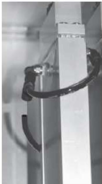
Vom T-Fitting abzogener Vakuumschlauch
