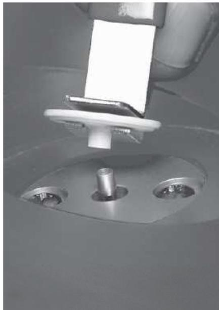
Platzieren des Filters auf dem „Tapered Element“
