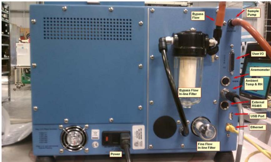
Abbildung 28: Ansicht Geräterückseite TEOM 1405-F Ambient Particulate Monitor
