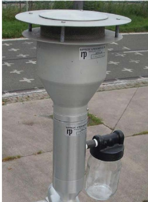
Abbildung 3: Amerikanischer PM<sub>10</sub>-Probenahmekopf (Original Style, p/n 57-000596-0001) für TEOM 1405-F Ambient Particulate Monitor
