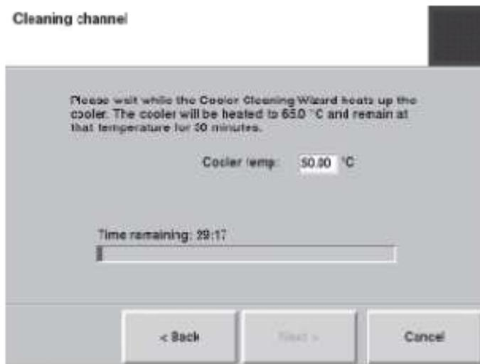
Anzeige „Reinigung der Kanäle“
