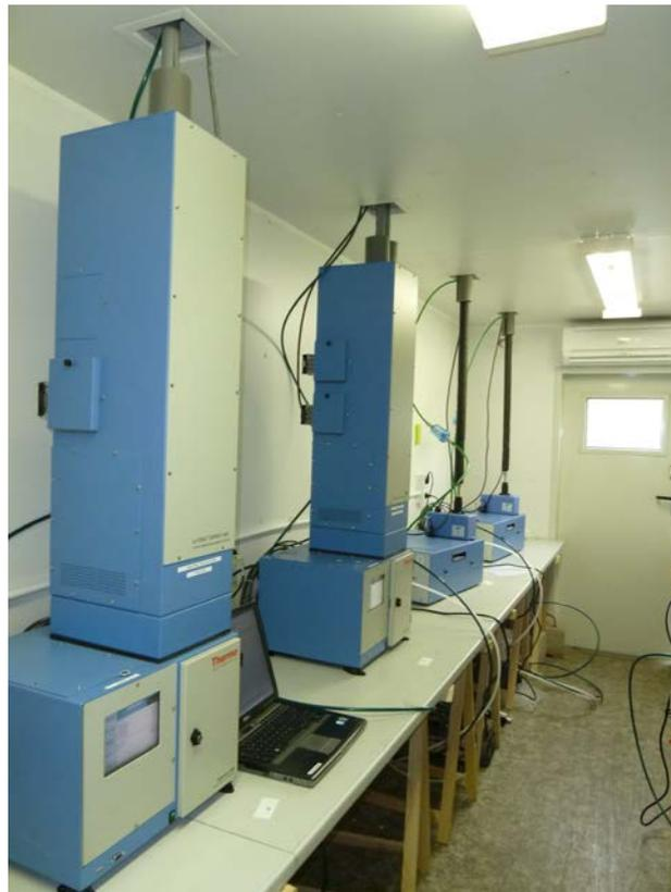
*Abbildung 6: Messgerät TEOM 1405-F Ambient Particulate Monitor (1. System von links) in Messstation*
