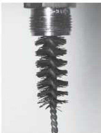
Ventil mit der Ventilbürste reinigen
