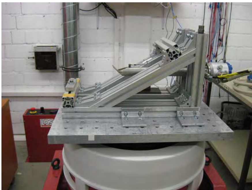
Abbildung 12: Aufbausituation Vibrationsprüfung für die X-Achse
