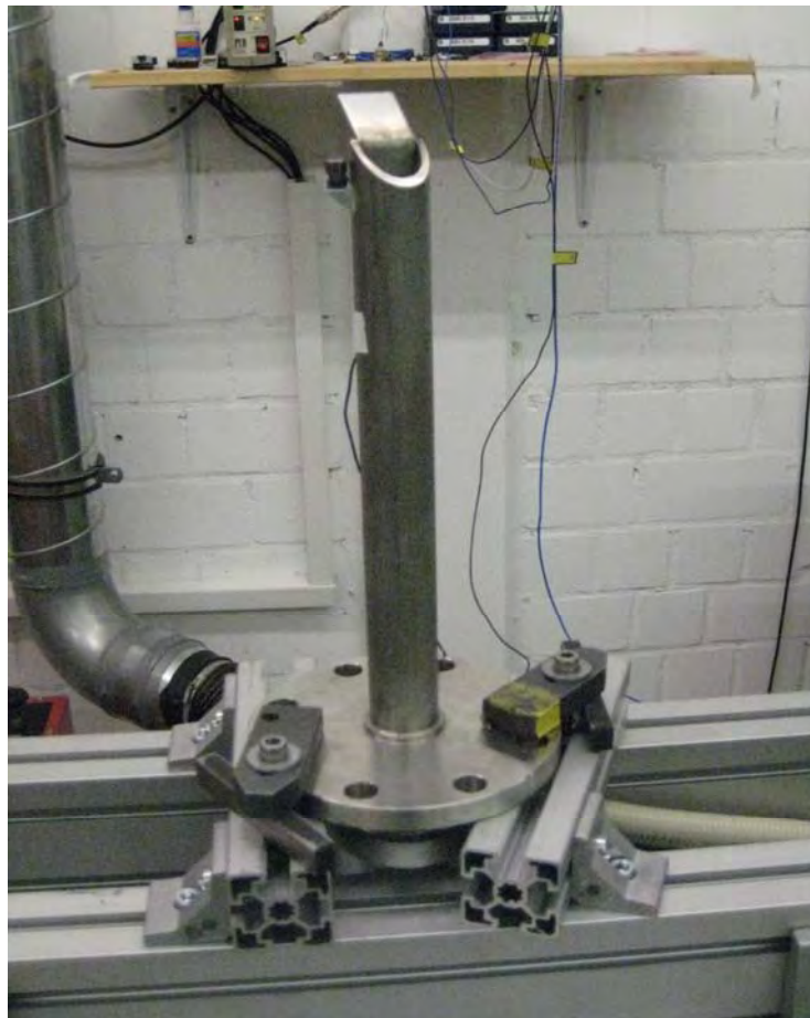
Abbildung 15: Aufbausituation Vibrationsprüfung für die Y-Achse
